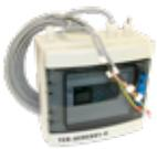
**Redundanz-Box:** Umschaltung zwischen zwei Innengeräten (oder Gruppen) im Störfall. Betriebsstundenabhängige Umschaltung; temperaturabhängiges Einschalten des zweiten Systemes. Plug & Play, LAN-Port, Monitoring über Web-Browser möglich.
