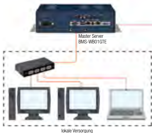
Systemdiagramm zur Verbindung von 2048 FCU-Geräten oder weniger
