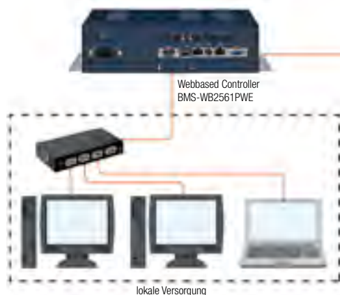
Systemdiagramm zur Verbindung von 256 FCU-Geräten oder weniger
