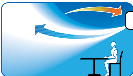
Richtiges Positionieren der Luftleitlamelle sorgt für zugfreien Komfort.
